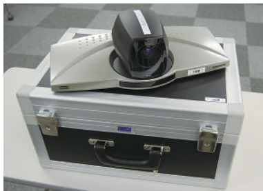
各支部が所有しているTANDBERG Set-top 770 MXPと、持ち運びのための特製ケース。モニターはプロジェクタースクリーンやテレビモニターを使用
